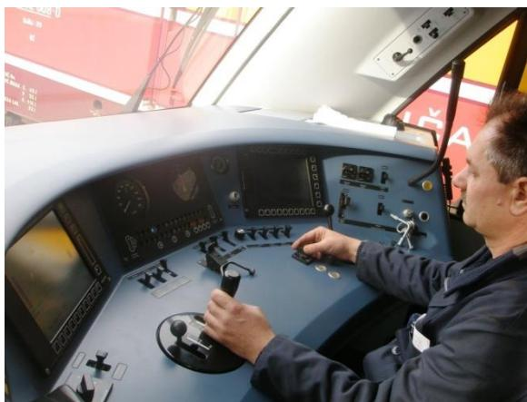
Slika 1.2. Ljeva ruka strojovođe na ergonomski oblikovanoj ručici kontrolera s rezervnom opcijom tastera za posluživanje budnika palcem lijeve ruke
