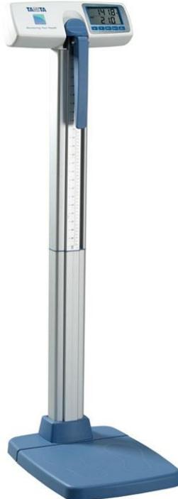
Slika 2.3. Digitalna vaga s mehaničkim visinomjerom Tanita WB 3000
