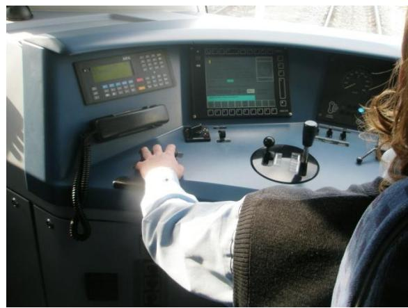
Slika 1.3. Pozicioniranje ručice kontrolera s tasterom za budnik i manje ručice za promjenu smjera kretanja u normalnom dosegu lijeve ruke ravno naprijed ispred lijevoga ramena vozača
