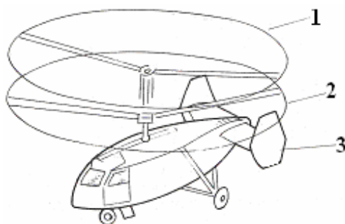
Slika 113. Helikopter s dva koaksijalna rotora 1. gornji nosivi rotor, 2. donji nosivi rotor, 3. repne površine
